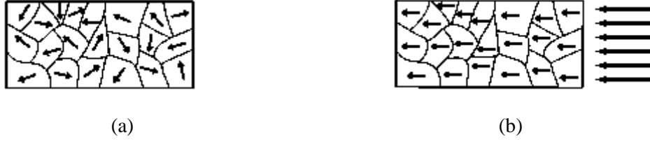
Şekil 1.13 (a) Genelde bir metalde bölgeler maddenin manyetize olmasını engeller. (b) Dışarıdan uygulanan manyetik alan altında bölgelerin yönelişi.
