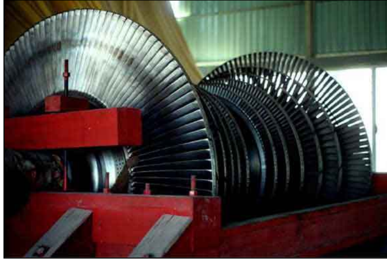
Şekil 6.3. 100 MW'lık bir türbin kesiti [56].
