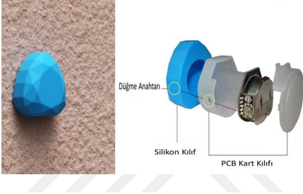
Şekil 2.2: Beacon cihazının kılıf içerisinde ve açık şekilde gösterimi [20].
