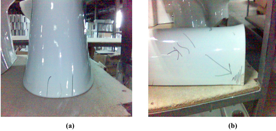
Şekil 2.16 Vitrifiye kalite kontrol prosesinde hata analiz örnekleri; a, b [17].
