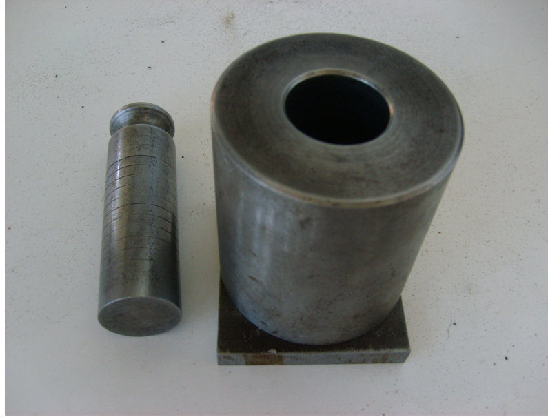
Şekil 5.3. Briketleme DeneYlerinde Kullanılan Silindirik Kalıp
