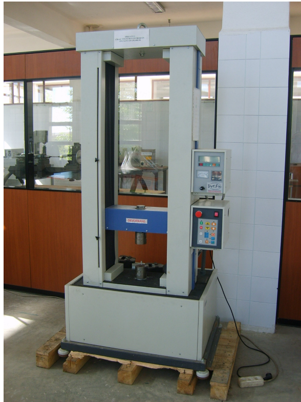
Şekil 5.4. Briketleme Kullanılan Hidrolik Pres Makinesinin Görünümü
