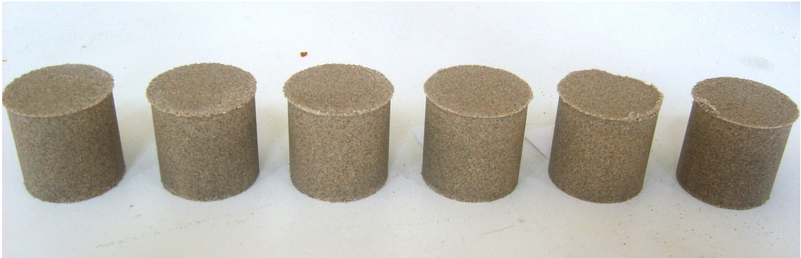
Şekil 5.5. Briketlenmiş Kalsine Kolemanit Numunelerinin Görünüşü
