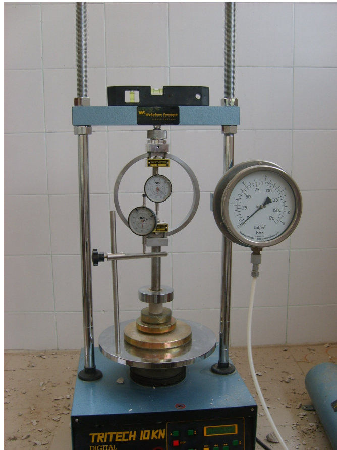
Şekil 5.6. Trittech Marka Tek Eksenli Basınç Cihazı
