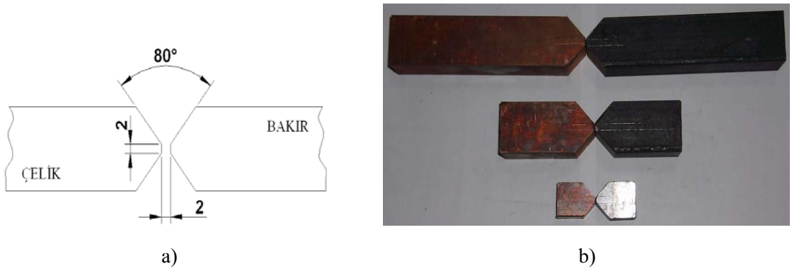
Şekil 5.1. Deney numunelerine açılan kaynak ağzı resimleri
