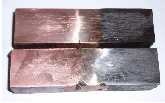
Şekil 5.3. Kaynak sonrası sertlik ölçümü yapılmış malzemeler.
