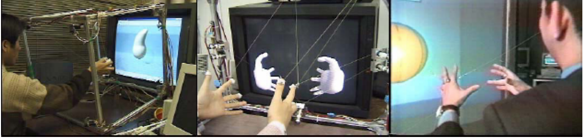
Şekil 2.9 Tel tahrikli dokunsal cihaz
