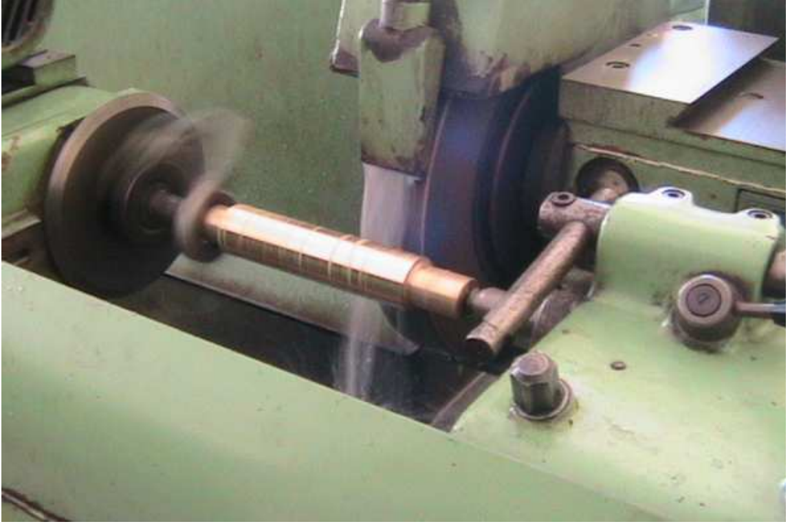
Şekil 7.3. Düz yüzeyli zımpara taşı ile bir numunenin taşlanması.
