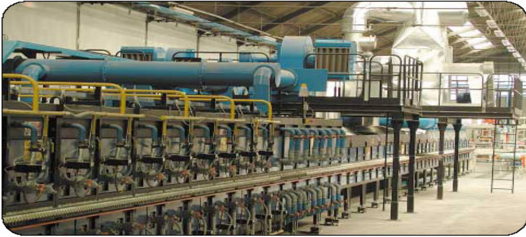
Şekil 4.4 Tek pişirim rulolu seramik fırını, kesit -1
