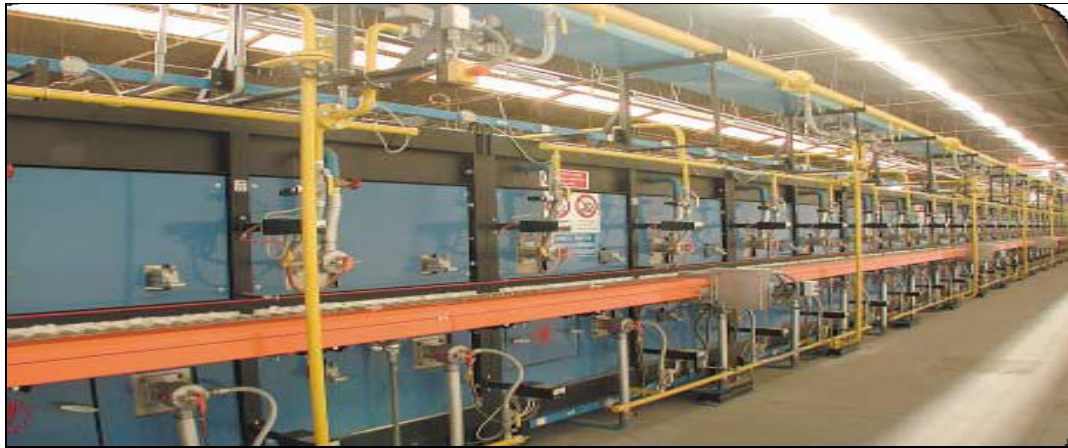
Şekil 4.5 Tek pişirim rulolu seramik fırını, kesit -2
