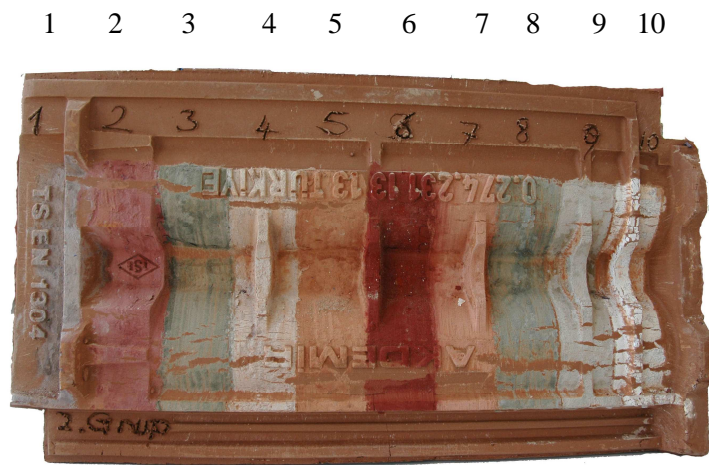
Şekil 5.12 “4.3.2” de hazırlanan numunelerin kiremit yüzeyine uygulama çalışmalarının 850 °C’de pişim sonucu
