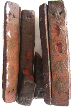
% 3 + % 6 Borik Asit ilaveli 1 ve 2 nolu numuneler 1000 C' DE pismis
