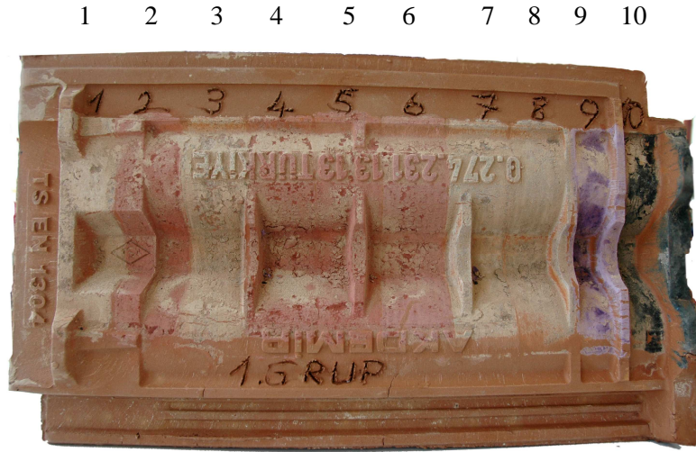
Şekil 5.14 “4.3.3” de hazırlanan numunelerin kiremit yüzeyine uygulama çalışmalarının 850 °C’de pişim sonucu
