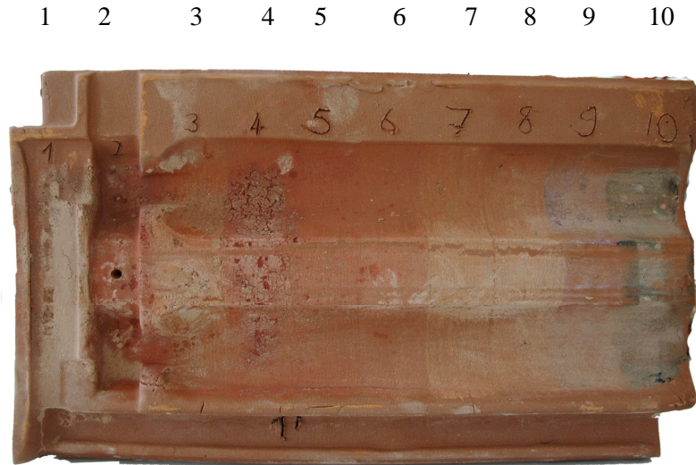
Şekil 5.17 “4.3.3” de hazırlanan numunelerin kiremit yüzeyine uygulama çalışmalarının 950 °C’de pişim sonucu(kauçuk yüzeyli presle)
