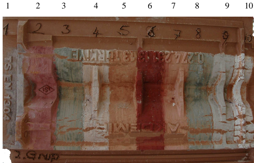
Şekil 5.19 “4.3.2”de hazırlanan numunelerin kiremit yüzeyine borik asit karışımıyla uygulamasının 850°C de pişirim sonucu.
