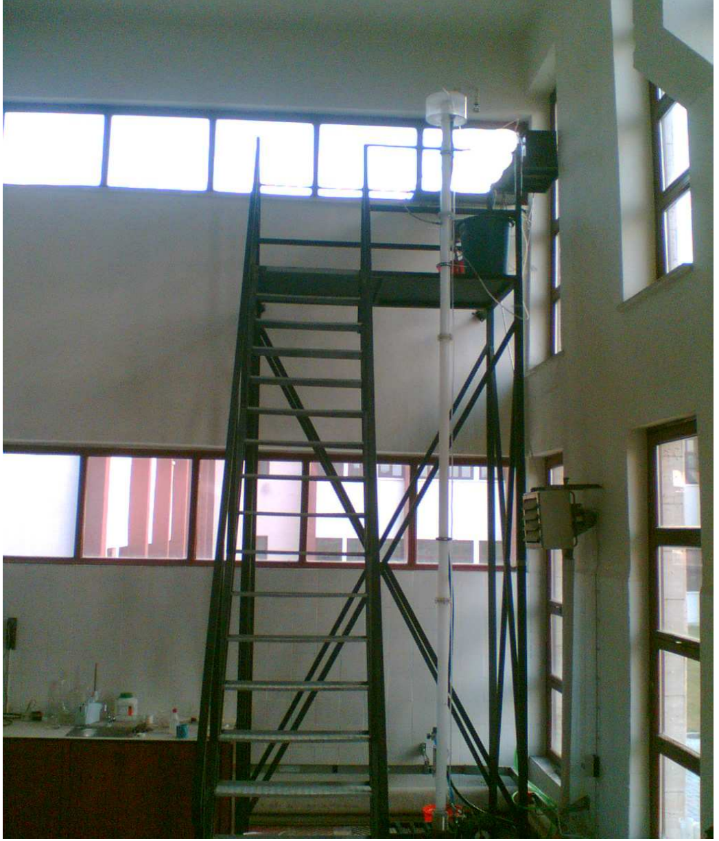
Şekil 4.4 DPÜ Müh.Fak.Maden Müh. Laboratuvarında bulunan flotasyon kolonu
