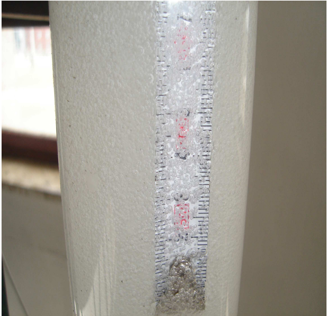
Şekil 4.7 Flotasyon Kolonunda Kabarcık Boyunun Ölçülmesi
