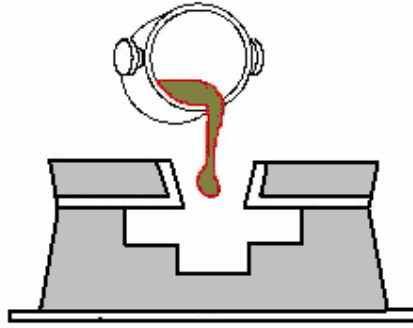
Şekil 2.4 Döküm ile şekillendirme [43].
