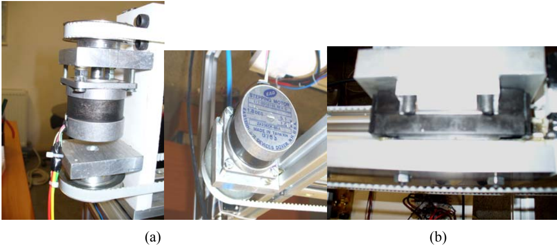
Şekil 4.20 Eksen hareketlerini sağlayan step motorları (a) ve minyatür araba(b)
