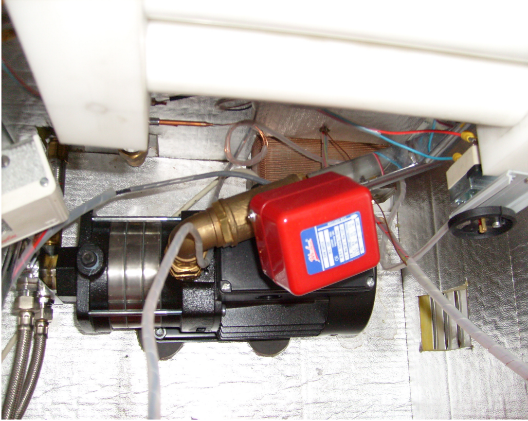
Ek 6 : Elektroşok ısıtma cihazının pompa ve presostat fotoğrafı
