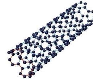
Şekil 1.2: Zikzak, koltuk ve kiral tek duvarlı karbon nanotüplerin gösterimleri [6].
