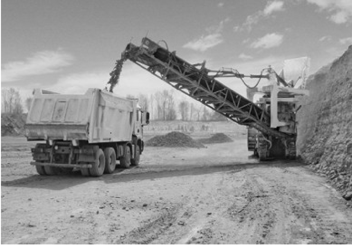
Şekil 3.5. Önden Tamburlu Bir Sürekli Yüzey Kazıcı [25]
