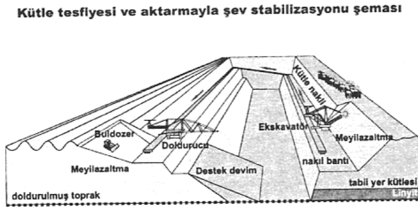
Şekil 5.17. Kütle aktarmayla şev meyili azaltılması
