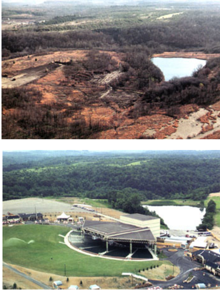
Şekil 4.15. Starvagi Ind. tarafından reklame edilen açık kömür ocağının ilk durumu ve yeniden kazanım dan sonra amfityatro haline getirilmiş durumu. ( Batı Virginia ABD.)
