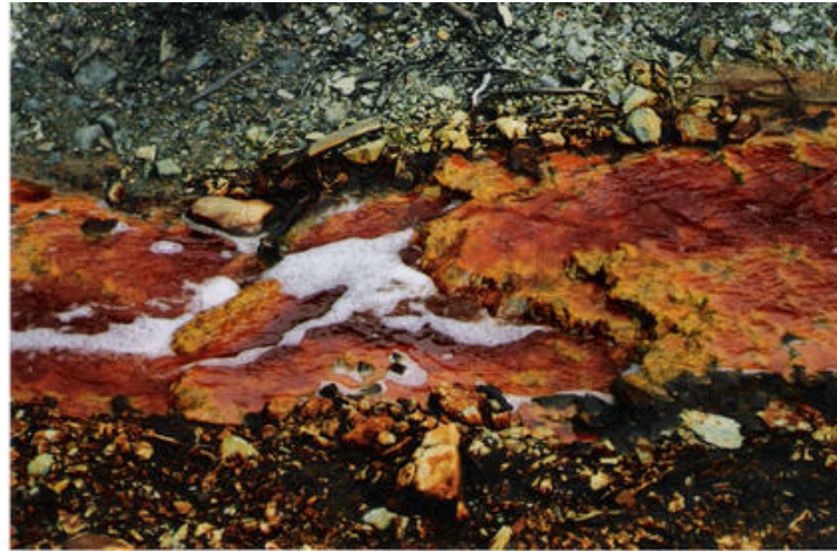
Şekil 5.21. Bu fotoğraf bir drenaj hendeğini gösteriyor. AMD nin 250.000 yıl daha devam edeceği öngörülüyor ve gelecek nesillerce de devam ettirilmeli.
