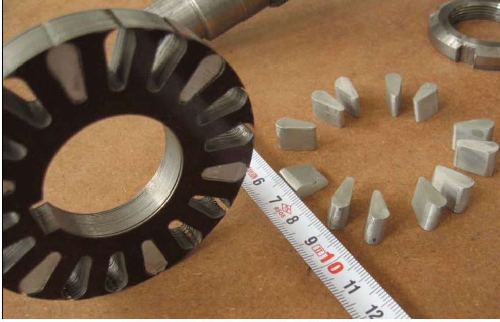
Şekil 4.5. İmal edilen rotor diski ve alüminyum iletkenleri
