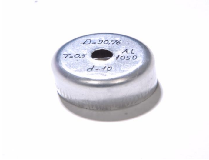
Şekil 4.9 Dış çapı 90,76 mm, delik çapı 10 mm, kalınlığı 0,5 mm olan Al 1050 alaşımlı alüminyum sacın hasara uğramadan derin çekilmiş hali.
