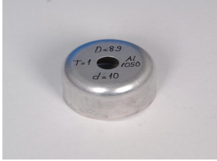
Şekil 4.13 Dış çapı 89 mm, delik çapı 10 mm, kalınlığı 1 mm olan Al 1050 alaşımlı alüminyum sacın hasara uğramadan derin çekilmiş hali.
