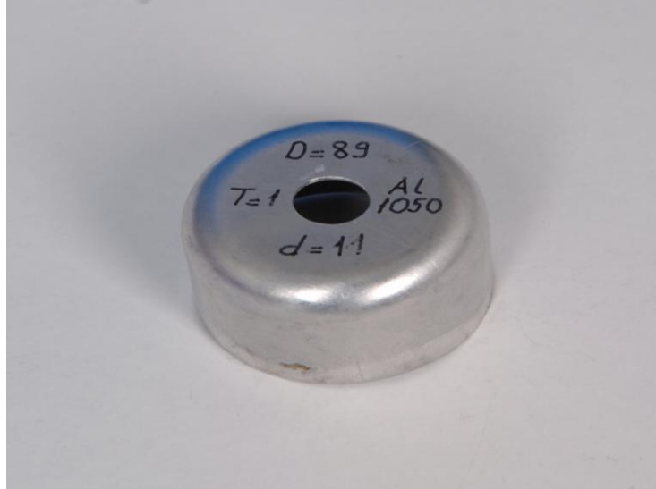
Şekil 4.14 Dış çapı 89 mm, delik çapı 11 mm, kalınlığı 1 mm olan Al 1050 alaşımlı alüminyum sacın derin çekilmiş hali.
