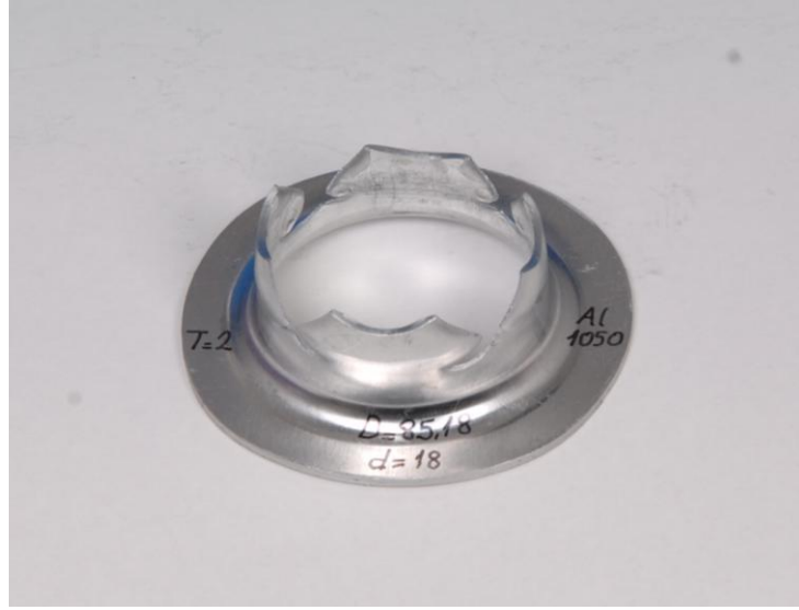
Şekil 4.23 Dış çapı 85,18 mm, delik çapı 18 mm, kalınlığı 2 mm olan Al 1050 alaşımlı alüminyum sacın derin çekilmiş hali.
