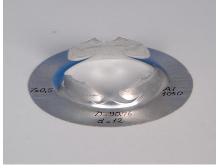
Şekil 4.11 Dış çapı 90,76 mm, delik çapı 12 mm, kalınlığı 0,5 mm olan Al 1050 alaşımlı alüminyum sacın derin çekme esnasında yırtılmış hali.
