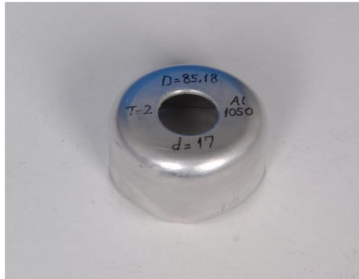
Şekil 4.22 Dış çapı 85,18 mm, delik çapı 17 mm, kalınlığı 2 mm olan Al 1050 alaşımlı alüminyum sacın derin çekilmiş hali.
