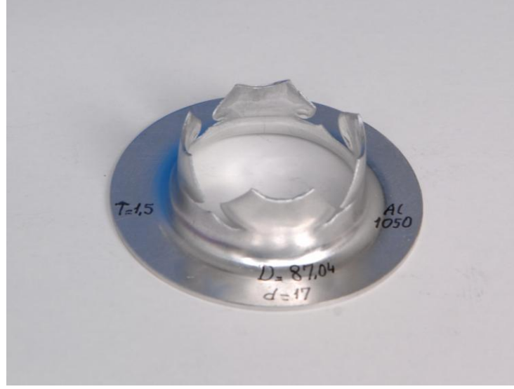
Şekil 4.19 Dış çapı 87,04 mm, delik çapı 17 mm, kalınlığı 1,5 mm olan Al 1050 alaşımlı alüminyum sacın derin çekilmiş hali.
