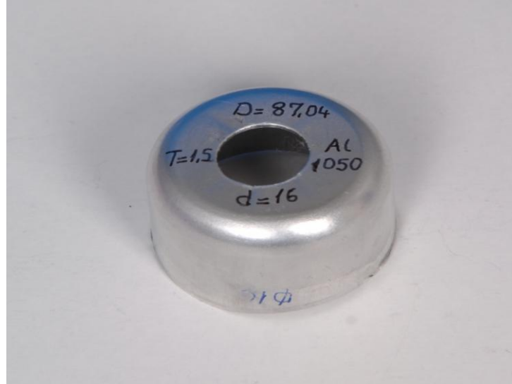
Şekil 4.18 Dış çapı 87,04 mm, delik çapı 16 mm, kalınlığı 1,5 mm olan Al 1050 alaşımlı alüminyum sacın hasara uğramadan derin çekilmiş hali.
