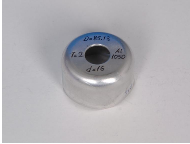
Şekil 4.21 Dış çapı 85,18 mm, delik çapı 16 mm, kalınlığı 2 mm olan Al 1050 alaşımlı alüminyum sacın derin çekilmiş hali.
