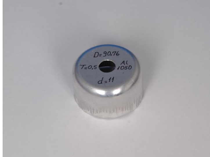
Şekil 4.10 Dış çapı 90,76 mm, delik çapı 11 mm, kalınlığı 0,5 mm olan Al 1050 alaşımlı alüminyum sacın derin çekilmiş hali.
