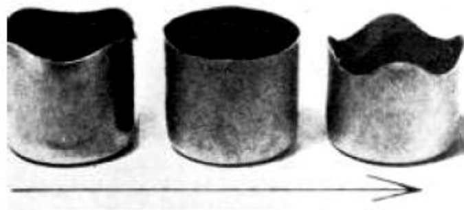
Şekil 3.12. Üç Farklı sac malzemenin derin çekilerek elde edilen iş parçalarında meydana gelen kulaklanma.
