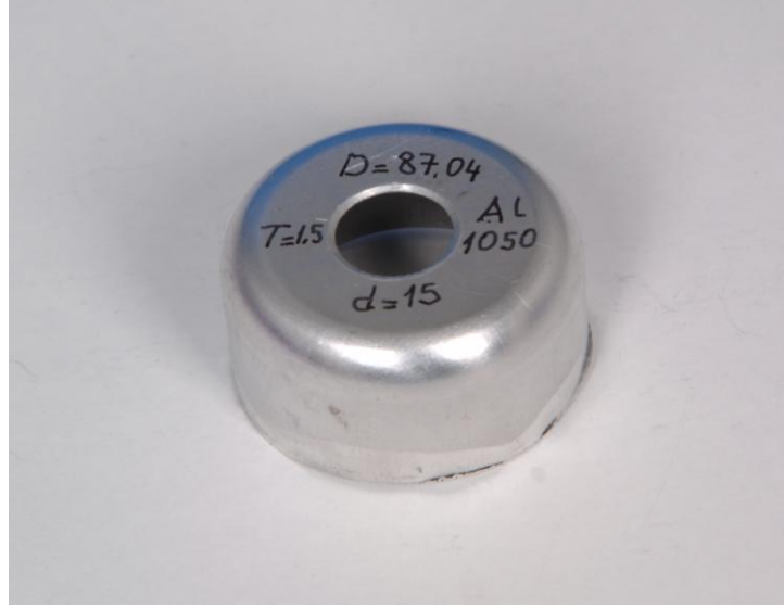
Şekil 4.17 Dış çapı 87,04 mm, delik çapı 15 mm, kalınlığı 1,5 mm olan Al 1050 alaşımlı alüminyum sacın derin çekilmiş hali.
