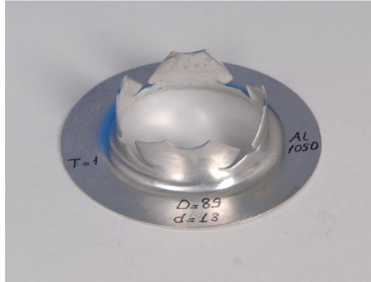
Şekil 4.16 Dış çapı 89 mm, delik çapı 13 mm, kalınlığı 1 mm olan Al 1050 alaşımlı alüminyum sacın derin çekilmiş hali.
