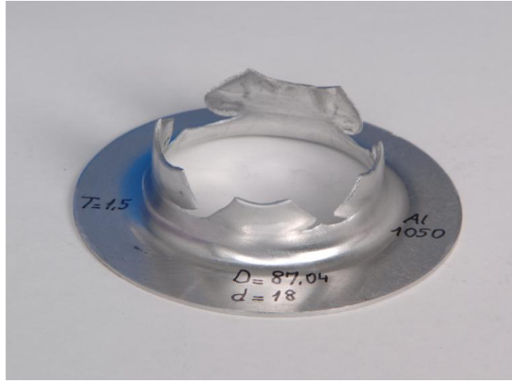
Şekil 4.20 Dış çapı 87,04 mm, delik çapı 18 mm, kalınlığı 1,5 mm olan Al 1050 alaşımlı alüminyum sacın derin çekme esnasında yırtılmış hali.
