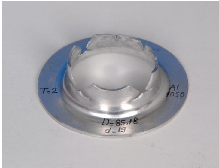
Şekil 4.24 Dış çapı 85,18 mm, delik çapı 19 mm, kalınlığı 2 mm olan Al 1050 alaşımlı alüminyum sacın derin çekilmiş hali.
