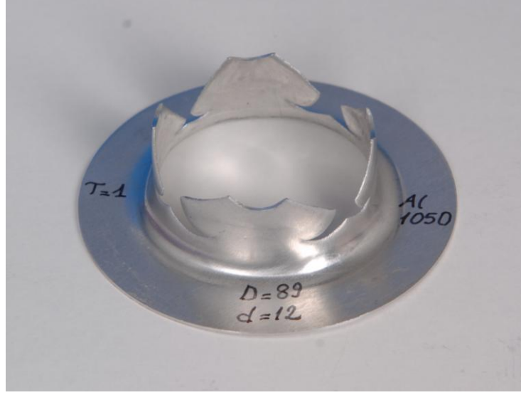
Şekil 4.15 Dış çapı 89 mm, delik çapı 12 mm, kalınlığı 1 mm olan Al 1050 alaşımlı alüminyum sacın derin çekilme esnasında yırtılmış hali.
