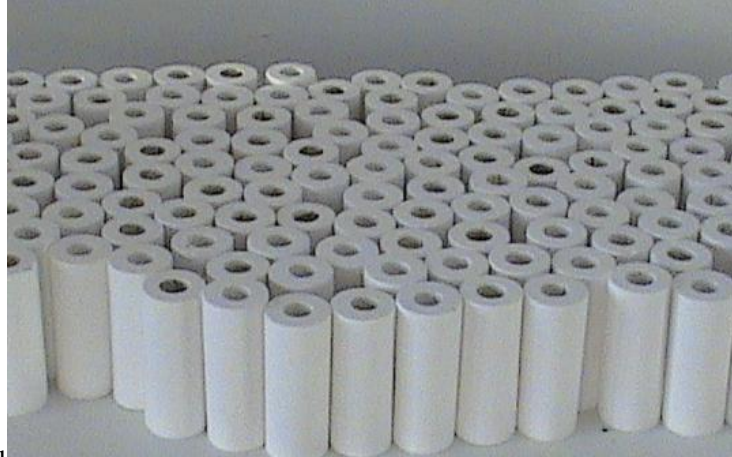
Şekil 3.5 Çift eksenli prese şekillendirilmiş gözenekli silindirik silika malzemelerin fotoğrafı.
