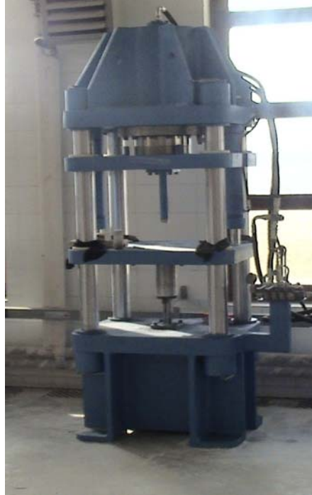
Şekil 3.4 Çift eksenli olarak silindirik malzemelerin şekillendirilmesini sağlayan presin fotoğrafı.
