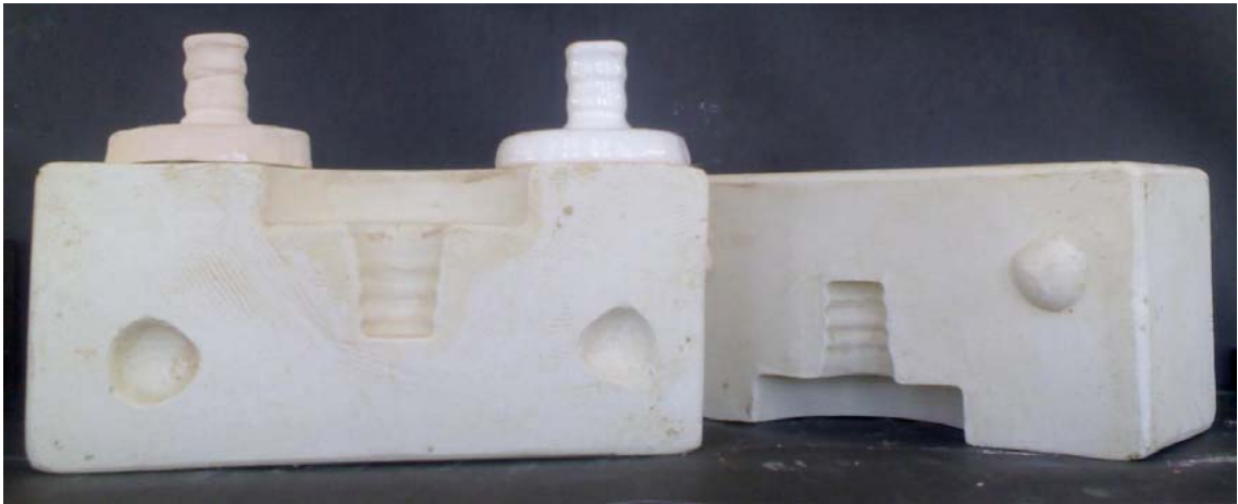
Şekil 3.8 Seramik filtre kapak kalıbı, bisküvi ve sırlanmış kapak görüntüsü.
