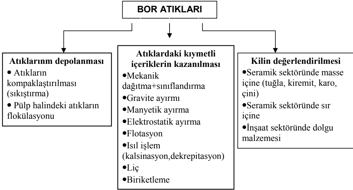
Şekil 3.1. Bor Atıklarının Değerlendirme Yöntemleri [6, 29, 30].
