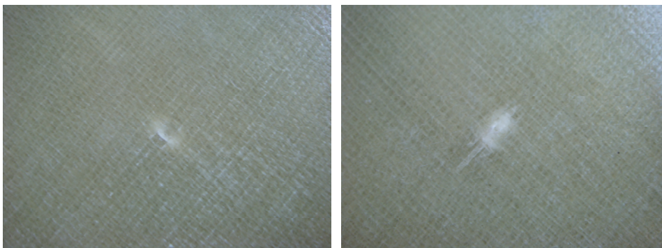
Şekil 5.53 [-45/45]_{4s} simetrik kompozit plak için 29.43J darbe enerjisinde oluşan; a) numune önü, b) numune arkası hasar durumu
