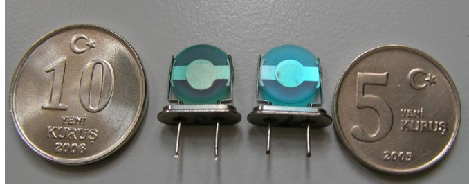
Şekil 2.4 Çalışmada kullanılan QCM sensör yapısı
