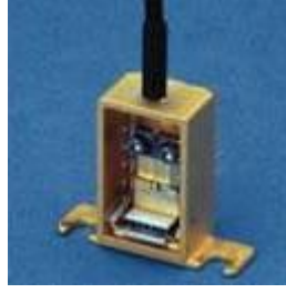
Şekil 3.24 TEC ile çalışan lazer diyodu[9,20].
