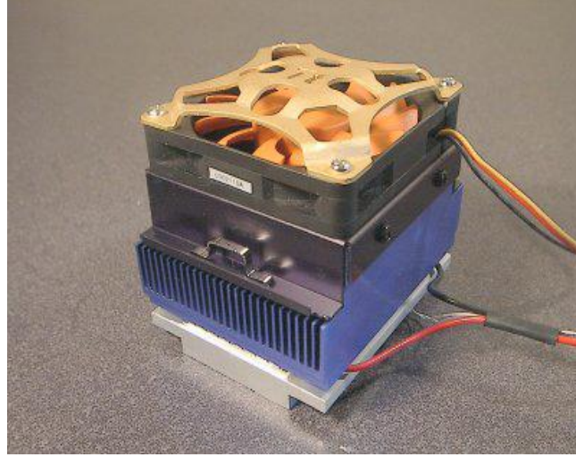
Şekil 3.31 Bir CPU soğutulması için tasarlanmış termoelektrik soğutucu[14].
