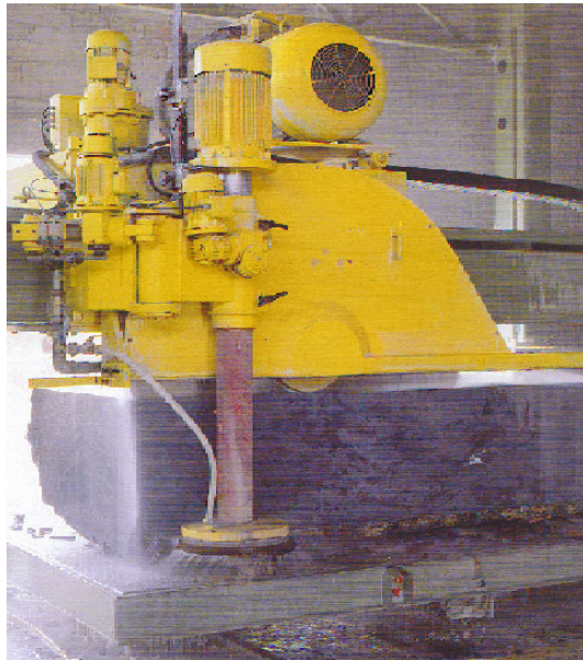
Şekil 2.6. S/T’de dikey ve yatay testere kesim anı [17]
