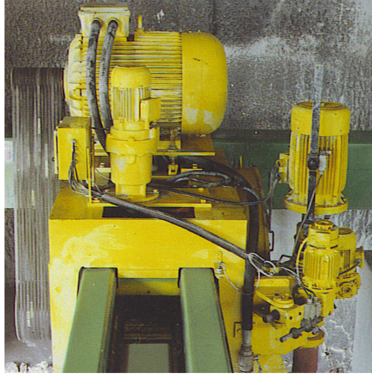
Şekil 2.4. S/T’de taşıyıcı köprü [117]
