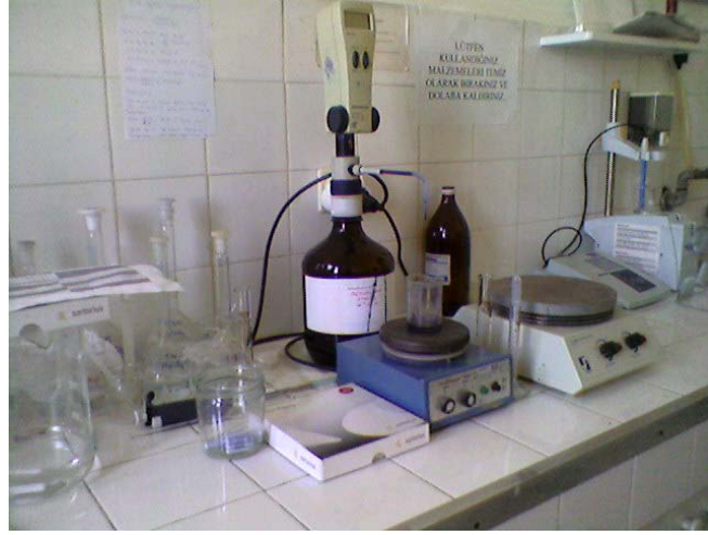
Şekil 7.10. Metilen Mavisi testi (Kasyon deęiřtirme Kapasitesi Tayini) Düzeneęi
