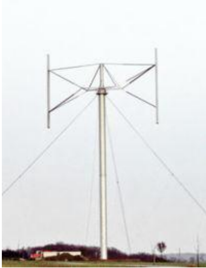
Şekil 3.2 Düz bir darrieus tipi rüzgâr türbini [37].
