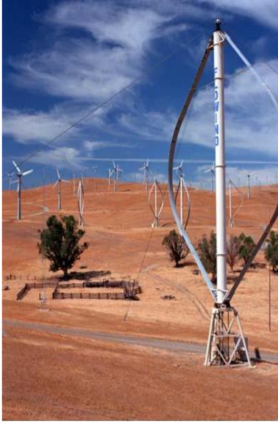
Şekil 3.1 – Düşey eksenli bir rüzgâr türbini [11,36].
