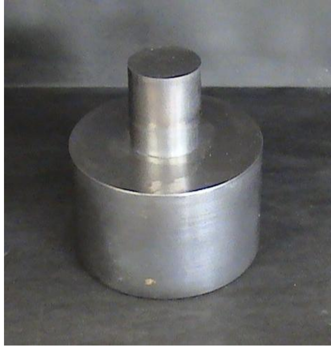
Şekil 5.3 Silindirik tablet şekillendirmede kullanılan kalıp görüntüsü.
