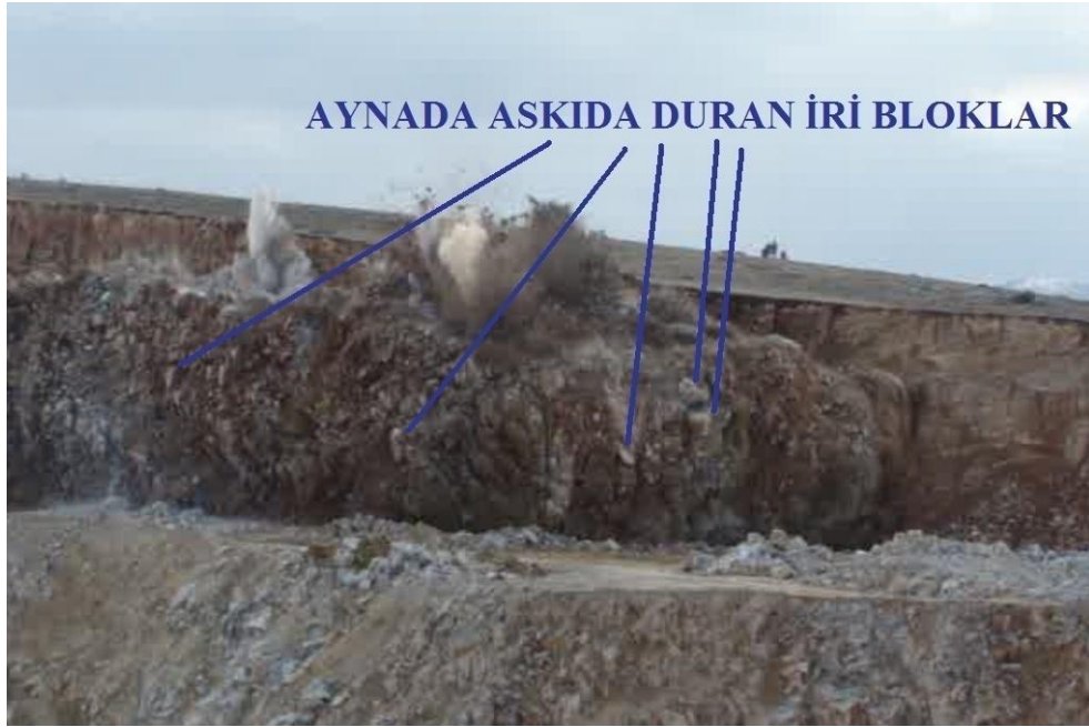
Şekil 2.16. Serbest aynada bulunan iri blokların kırılmadan hareketlenmesi.
