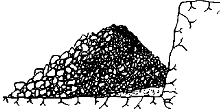
Şekil 2.14. Patlatılmış malzemedeki tane dağılımı [59].
