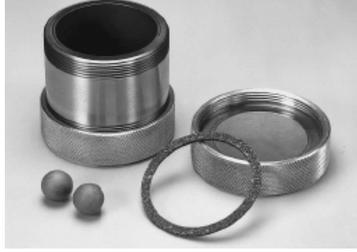
Şekil 6.2 Tungsten karbür' den yapılmış SPEX tipi (Salımlı) karıştırıcının; Öğütme kabı, kapak, conta ve bilyelerden oluşan öğütme hücresi [52].
