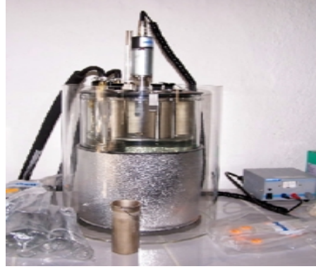
Şekil 3.17 Akma ve bulutlanma noktası ölçüm cihazı.
