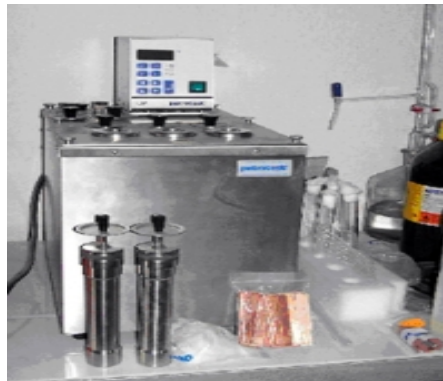
Şekil 3.15 Bakır şerit korozyon test cihazı.
