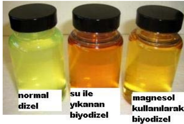
Şekil 3.12 Metil ester yıkama işlemi sonrası biyodizel renkleri.
