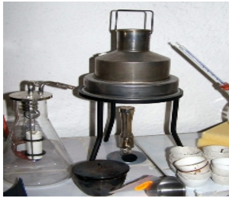
Şekil 3.18 Karbon kalıntısı tayin cihazı.
