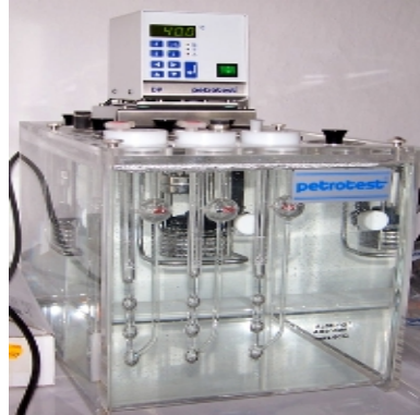
Şekil 3.16 Kinematik viskozite ölçüm cihazı.
