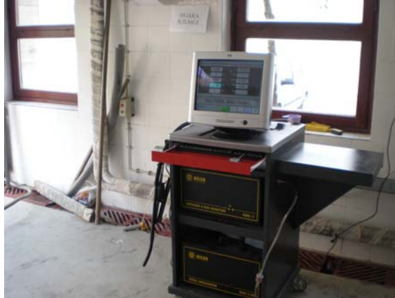
Şekil 5.2 Egzos gaz emisyonları analiz cihazı.
