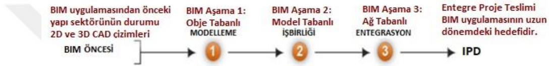
Şekil 2.2: BIM olgunluğunun üç alt aşamaya ayrılmasının lineer gösterimi (Succar,2009).
