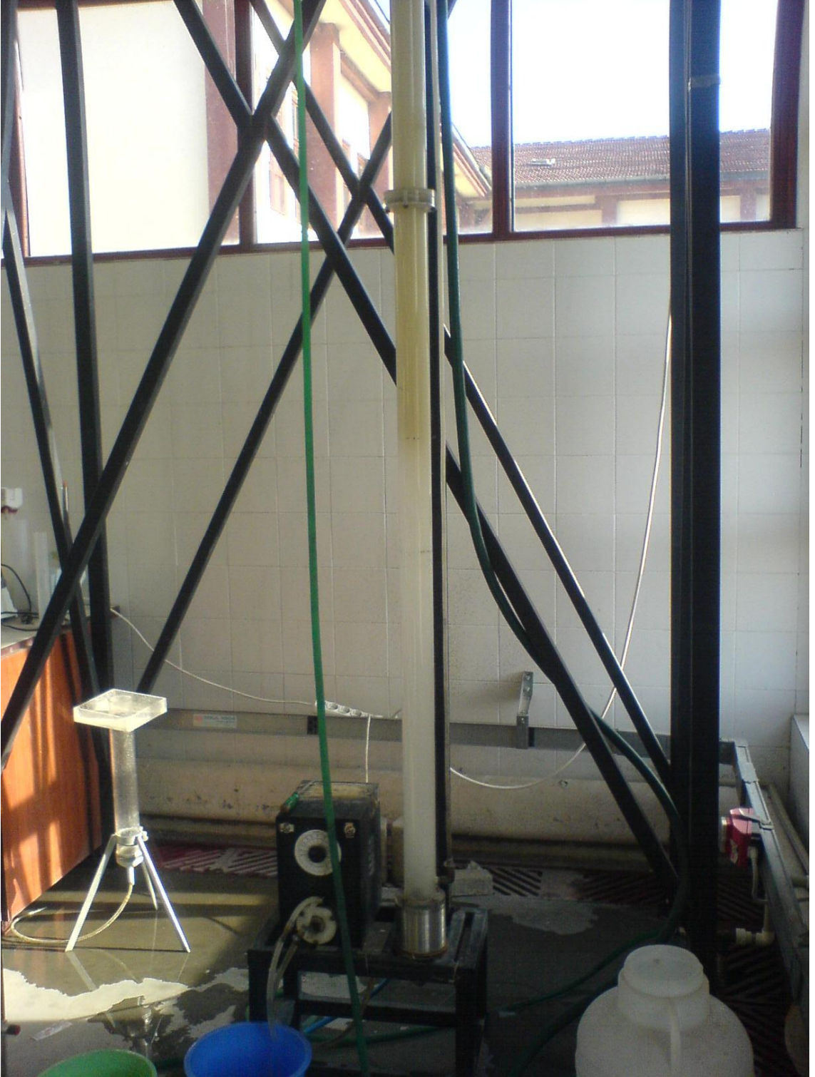
Ek Şekil 3. Flotasyon kolonunda kolemaniti zenginleştirme deneyleri
