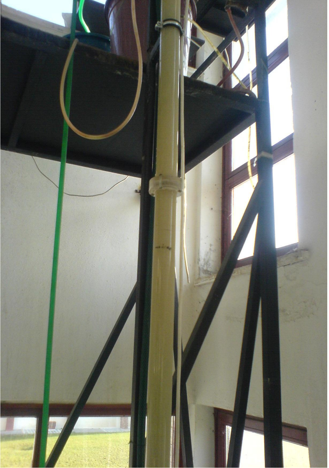
Ek Şekil 2. Flotasyon kolonunda kolemaniti zenginleştirme deneyleri
