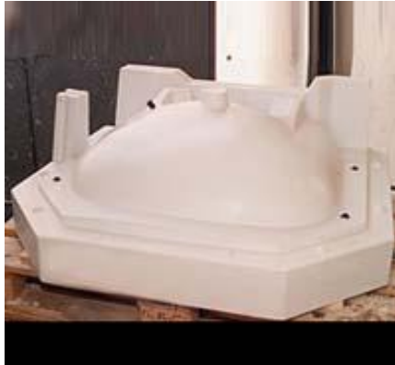
Şekil 6.3 Vitriye üretiminde kullanılan alçı kalıplar [34].
