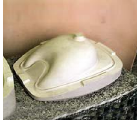
Şekil 6.3 Vitriye üretiminde kullanılan alçı kalıplar [34].
