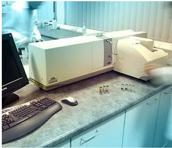
Şekil 7.1 Lazer difraksiyon yöntemine dayalı olarak ölçüm yapılan Malvern MasterSizer 2000 cihazı [40].
