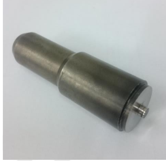
Şekil 5.1: Deneyleerde kullanılan pim tipi ve karıştırıcı boyut ölçüleri.
