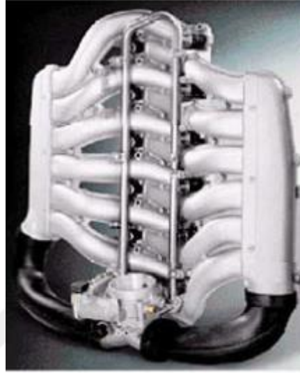
Şekil 2.8: AZ91HP- Basınçlı döküm ile üretilmiş emme manifoldu [22].
