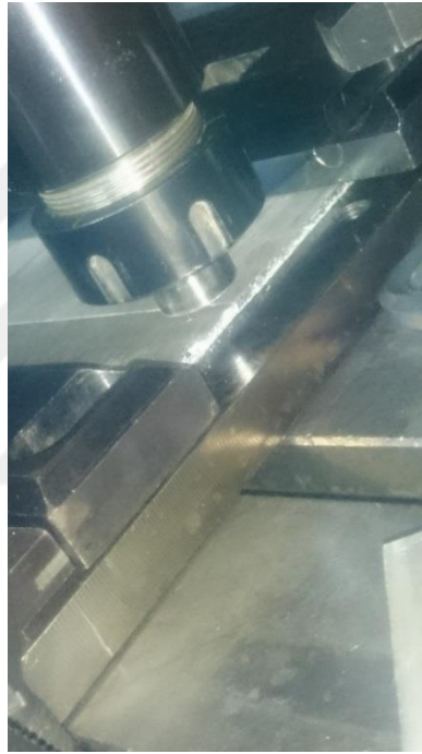
Şekil 5.4: SKK kaynağının yapılışı.
