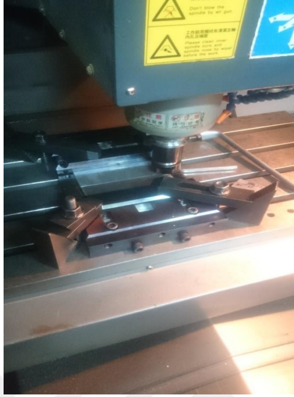
Şekil 5.3: Levhaların bağlama kalıbı ile tezgâha sabitlenmesi.
