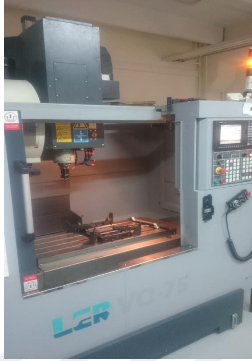
Şekil 5.2: SKK kaynağında kullanılan CNC freze (LER VQ-75).
