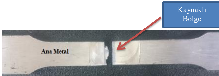
Şekil 6.7: Doğrulama numunesi kopma bölgesi.
