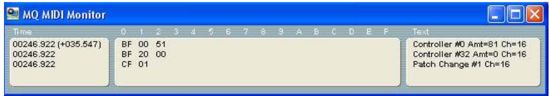
16. Kanal üzerinde Program change mesajının (patch change) MIDI Quest yazılımı üzerindeki monitör görüntüsü. (1 nolu programa geçilmiş)
