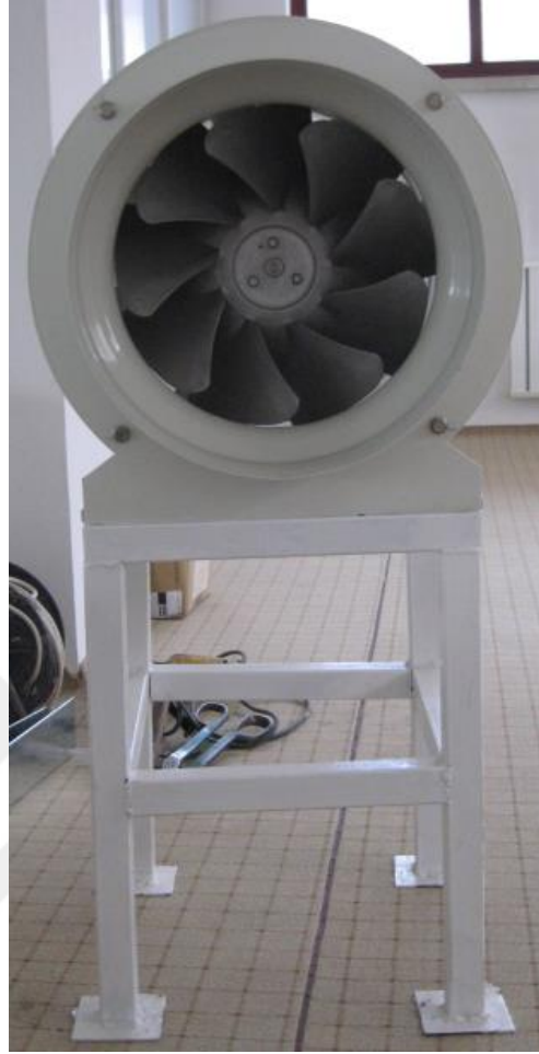
Şekil 5.14. Sistemde kullanılan üfleyici vantilatör
