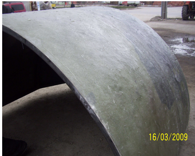
Şekil 9.7 Biyogaz reaktörü fiber malzeme ana kalıbı.
