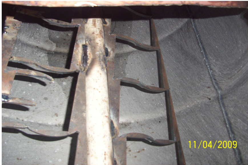
Şekil 9.5 Gübre ön hazırlama ünitesi karıştırıcı sistemi.
