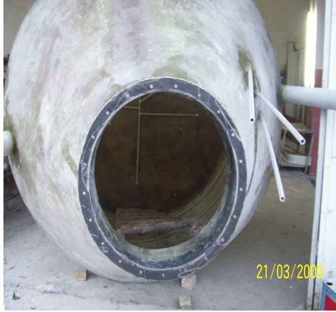
Şekil 9.8 Fiber malzemedan yapılmış biyogaz reaktörü.
