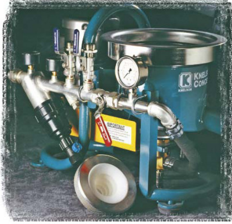
Şekil 3.1 Knelson konsantratör ve şematik görünüşü [91]
