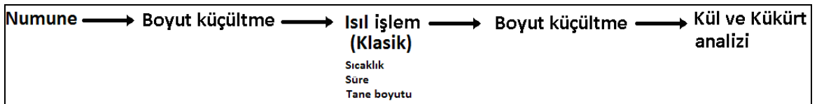
Şekil 4.17 Isıl işlem (klasik) deneyi prensip akım şeması
