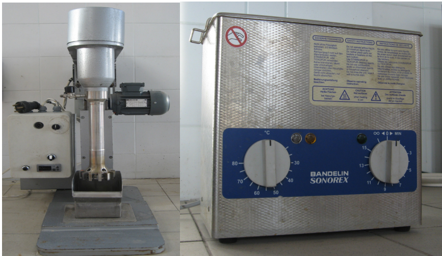
Şekil 4.13 Deneylerde kullanılan flotasyon makinesi ve ultrasonik banyo
