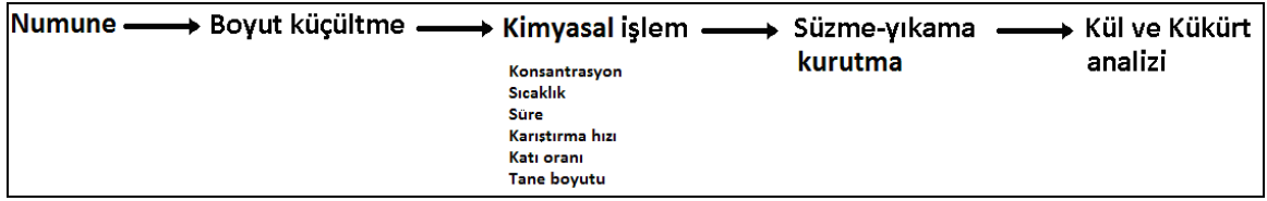
Şekil 4.16 Kimyasal işlem (asidik) prensip akım şeması
