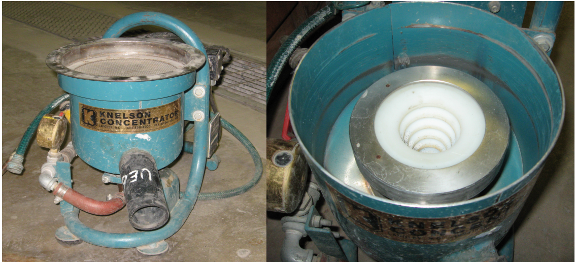
Şekil 4.11 3 inç çaplı laboratuvar tipi Knelson konsantratör
