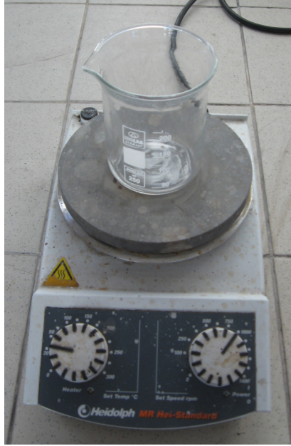
Şekil 4.15 Deneylerinde kullanılan manyetik karıştırıcı
