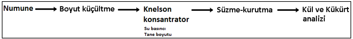
Şekil 4.10 Knelson konsantratör deneyi prensip akım şeması
