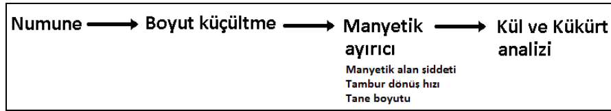
Şekil 4.9 Manyetik ayırma deneyi prensip akım şeması
