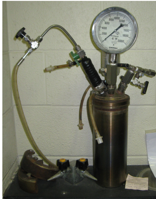
Şekil 4.21 Deneylerde kullanılan otoklav cihazı
