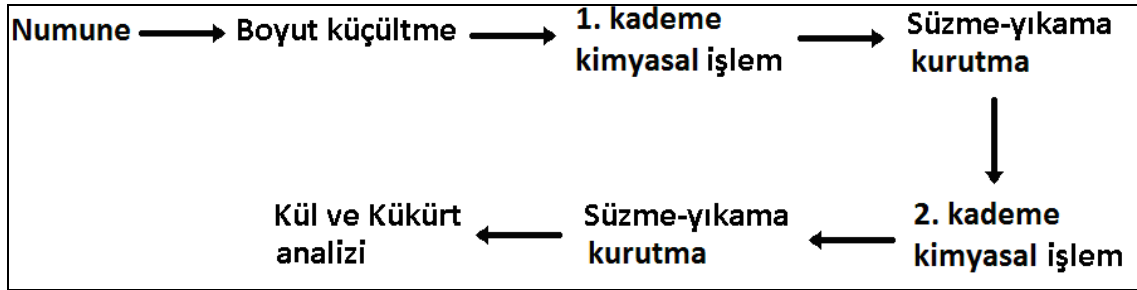
Şekil 4.24 İki kademeli kimyasal yöntem prensip akım şeması
