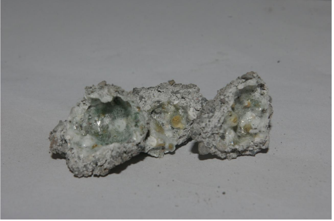
Ek 3.5 Mikrodalga işlem esnasında oluşan aglomerat örnekler.
