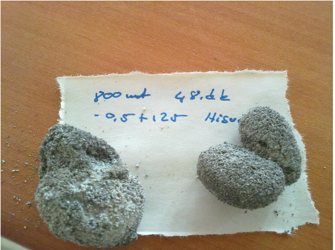
Ek 3.4 Mikrodalga işlem esnasında oluşan aglomerat örnekleri.
