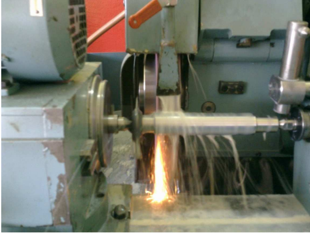
Şekil 6.6 Düz yüzeyli zımpara taşı ile bir numunenin taşlanması.
