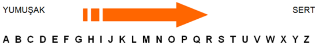
Şekil 3.2 Zımpara taşı sertlik skalası[2].
