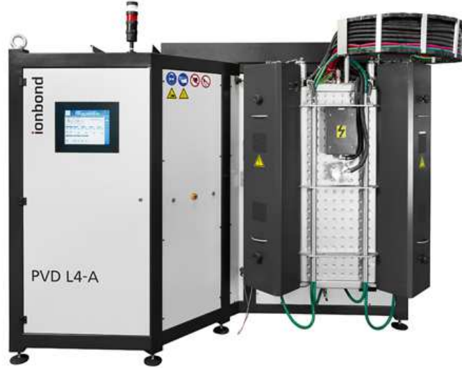
Şekil 3.3 Roadrunner, PVD kaplama cihazı (Ionbond, 2012).
