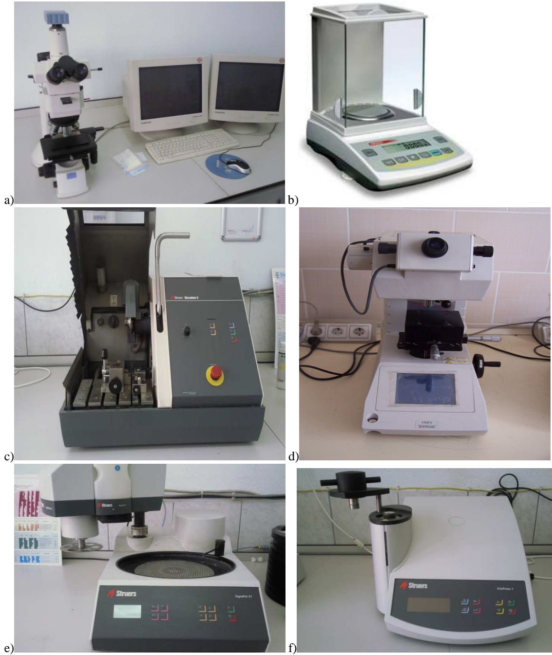
Şekil 7.3 Deneysel çalışmada kullanılan cihazlar: a) Görüntü analiz sistemi, b) Hassas terazi, c) Struers Discotom-5 kesme cihazı, d) Sertlik ölçüm cihazı, e) Struers Tegrapol-21 zımpara ve parlatma cihazı, f) Struers bakalite alma cihazı (Karakaplan, 2011).
