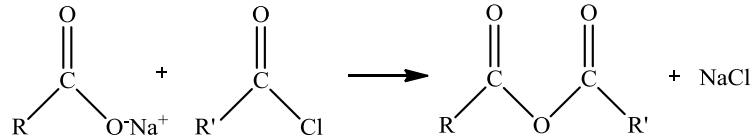
Şekil 3.14 Karboksilik asit sodyum tuzundan anhidrit eldesi
