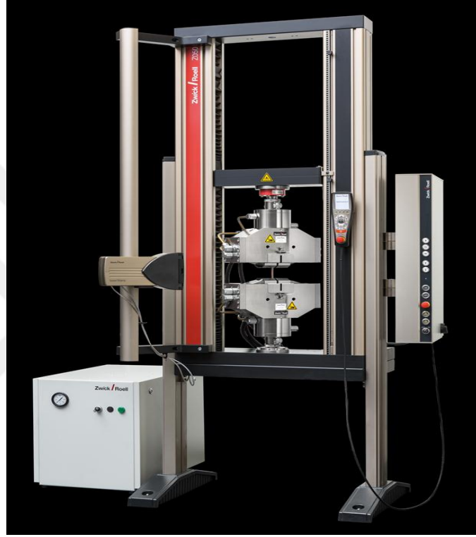
Şekil 2.11: Çekme testinde kullanılan test makinesi.
