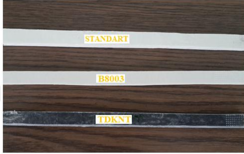
Şekil 2.10: Çekme testinde kullanılan kompozit çubuklar.
