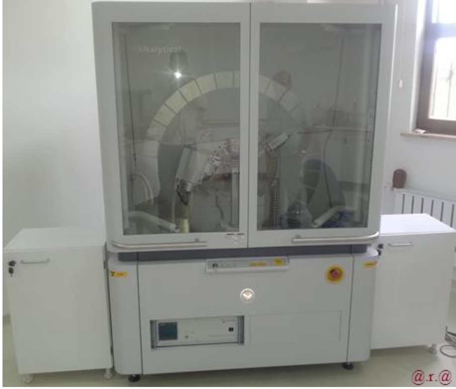
Şekil 7.15. Kullanılan X-ışınları toz difraktometresinin fotoğrafı.
