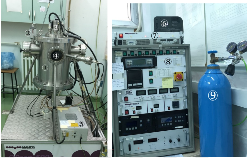
Şekil 3.1: DC magnetron püskürtme sistemi ve bu sisteme ait temel bileşenler.
