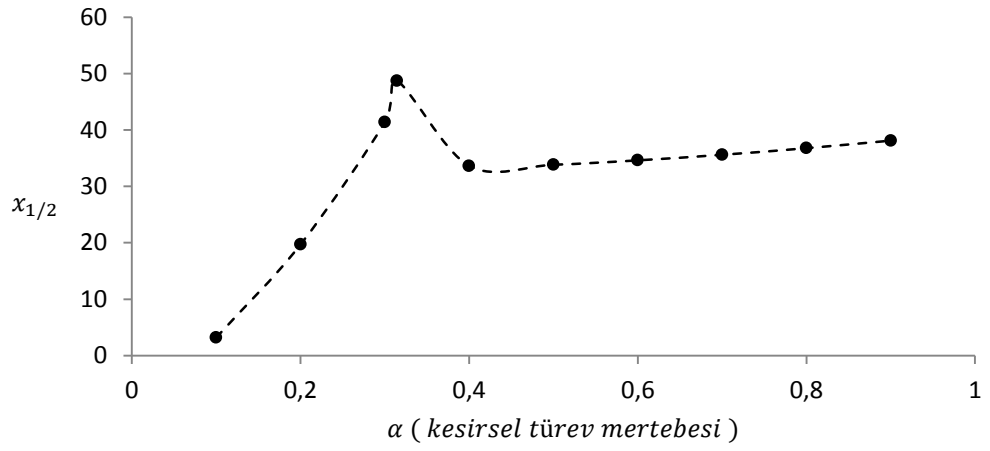
Şekil 4.21. ^{36}\text{Cl} Beta kaynağı için farklı kesirsel türev mertebelerine göre yarı-değer kalınlığı değişimi.
