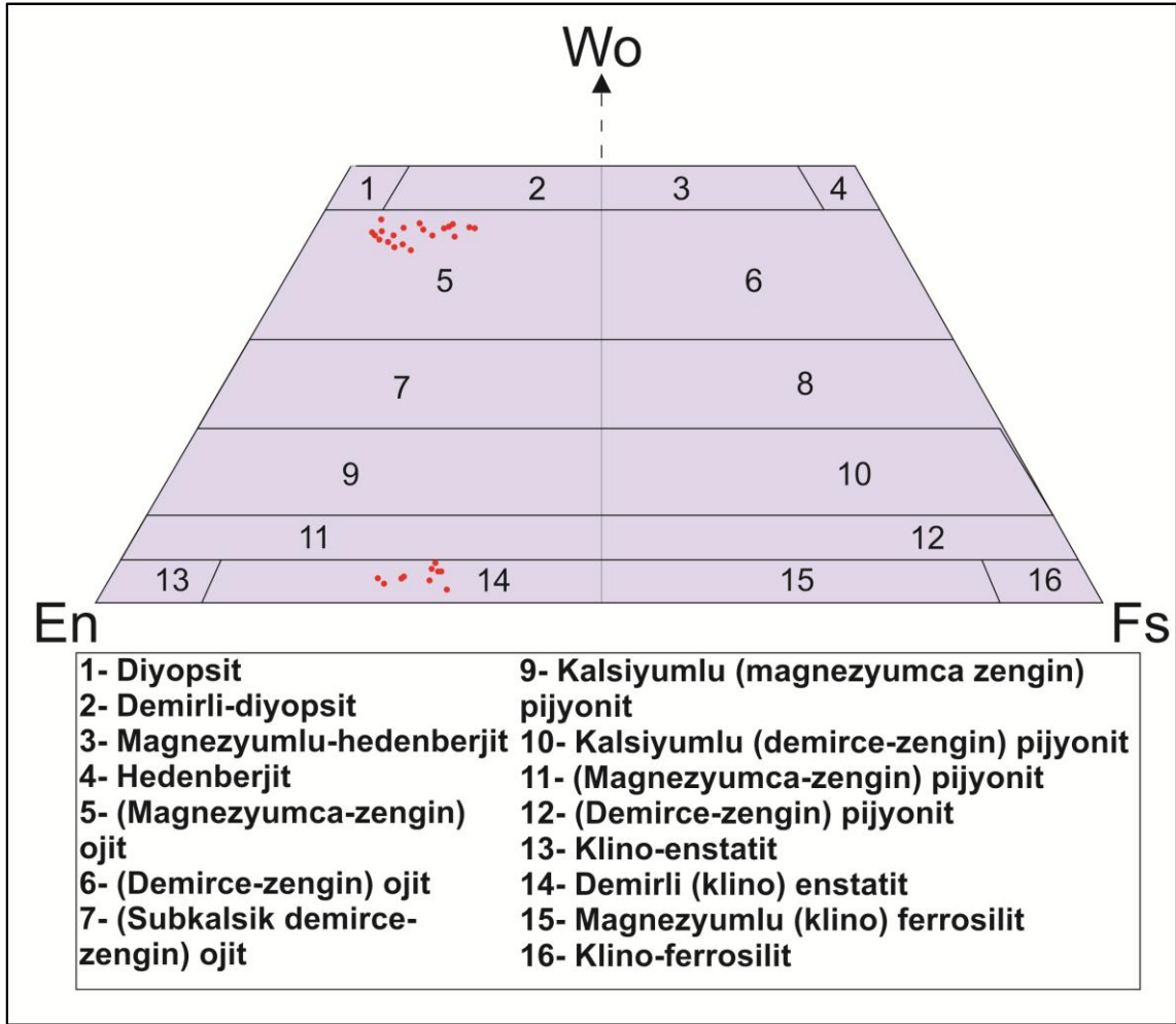
Şekil 4.4. Piroksenlerin Wo-En-Fs ikizkenar dörtgen diyagramı (Rock, 1990).
