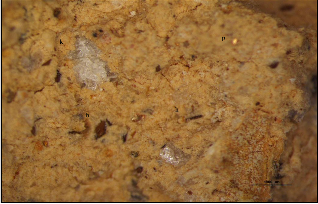
Şekil 5.23. 1000 °C ısıda Kütahya tüfünün optik mikroskop görüntüsü
