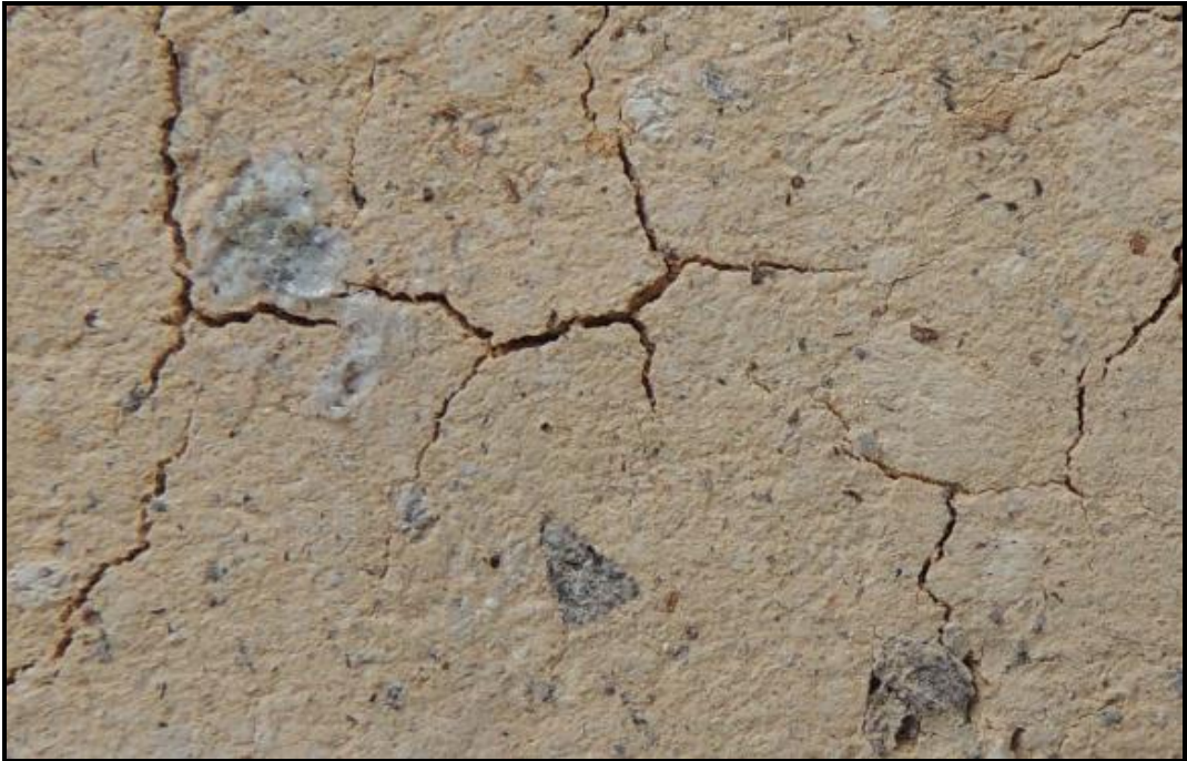
Şekil 5.19. 1000 °C sıcaklıkta tuf numunesi (kayaç parçası etrafında çatlak genişlemesi)
