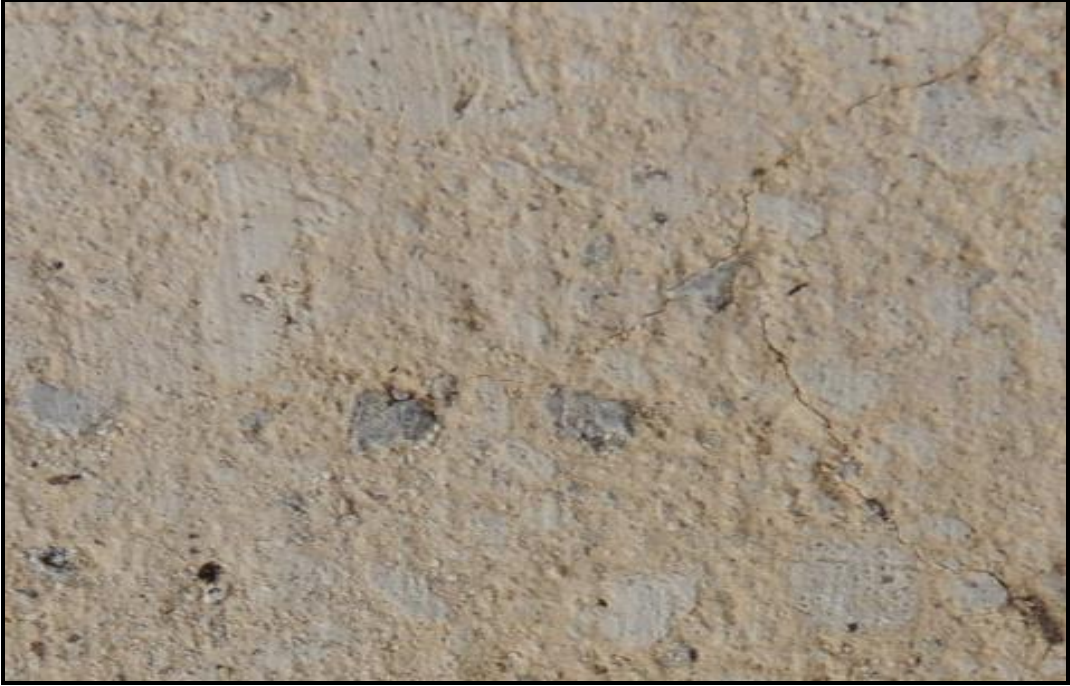
Şekil 5.18. 900 °C sıcaklıkta tuf numunesi (İnce çatlaklar)
