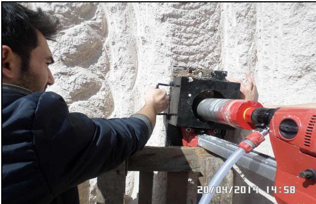
Şekil 4.1. Karot kesme aleti ile yerinde numune alınması.
