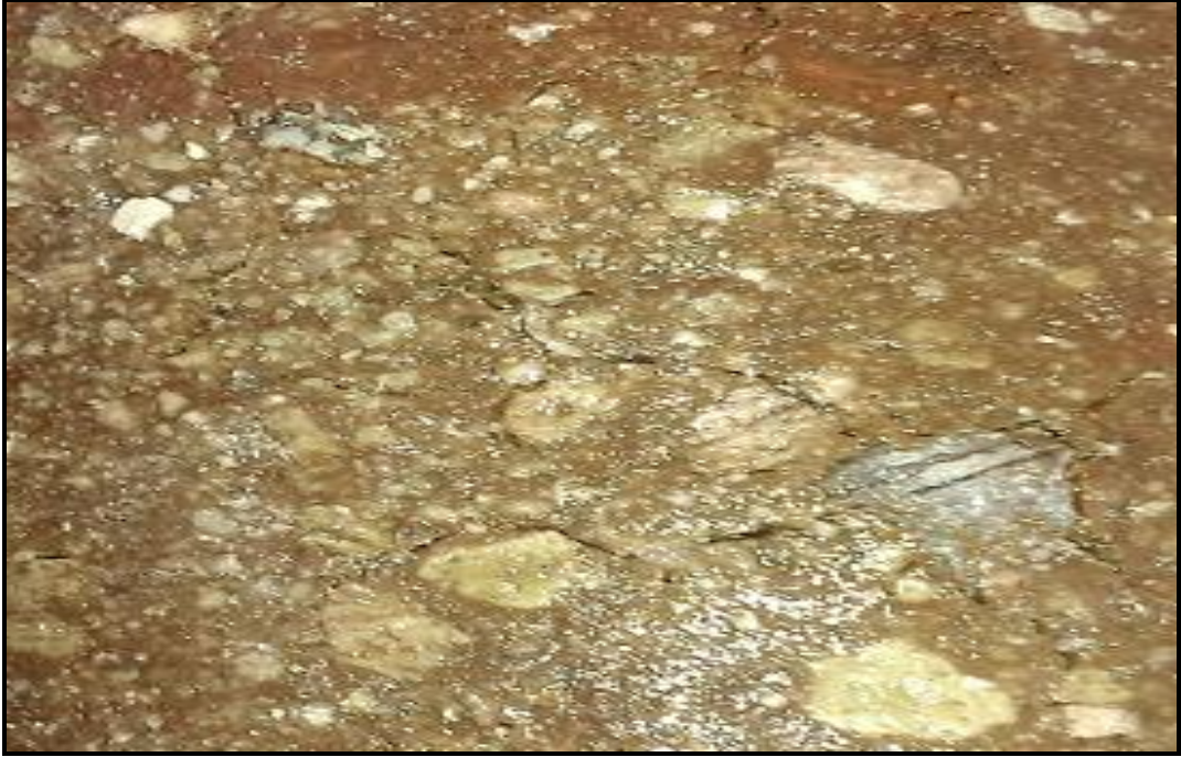
Şekil 5.21. 1200 °C sıcaklıkta tuf numunesi (Camsı yapı)
