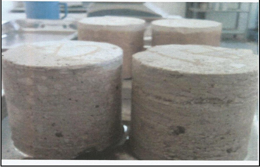
Şekil 4.4. Kapiler su emme deneyi fotoğrafı
