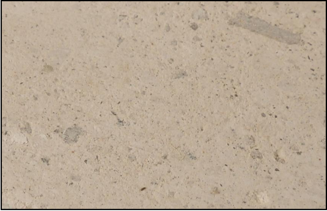
Şekil 5.17. Tüf numunesi (Bağlayıcı hamur ve etrafında farklı taneler)
