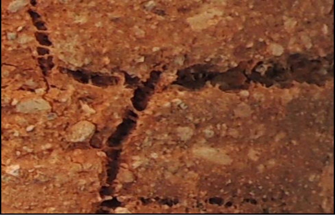
Şekil 5.20. 1100 °C sıcaklıkta tuf numunesi (derin çatlaklar ve camsı yapının sertleşmiş hali)
