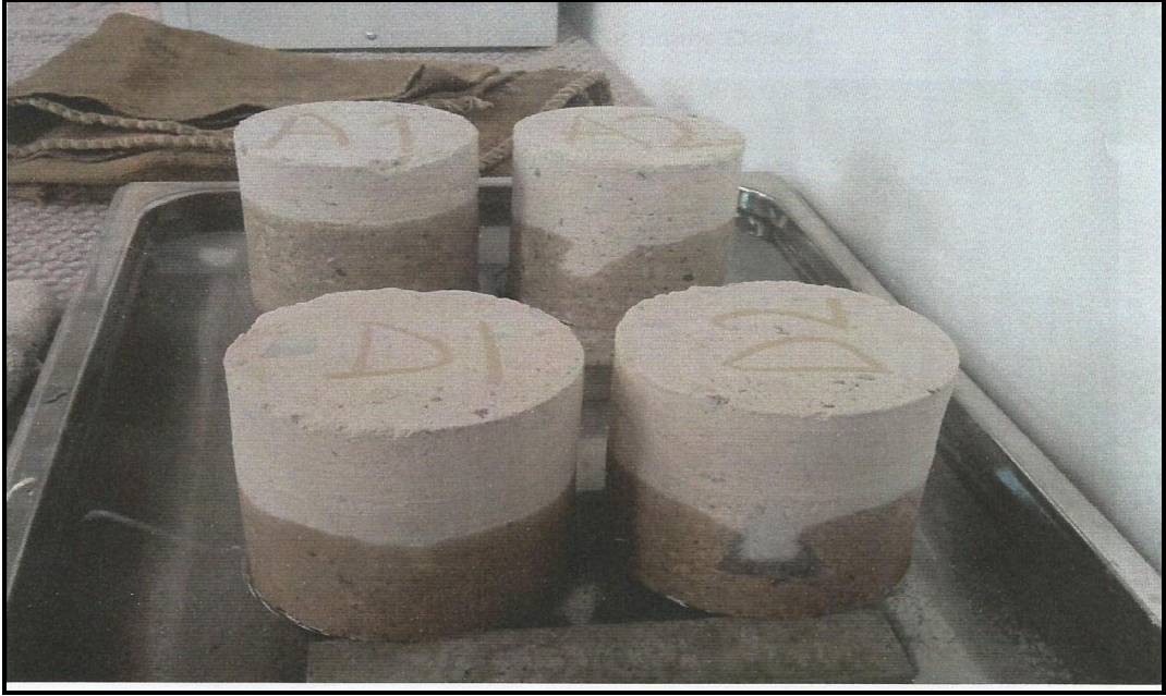
Şekil 4.3. Kapiler su emme deneyi fotoğrafı
