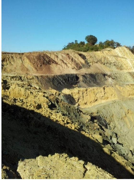
Şekil 3.3. Kömür damarının altında, konumu K 50 D/70 KB olan 5-nolu eğim atımlı normal fay (Kahraman, 2014).
