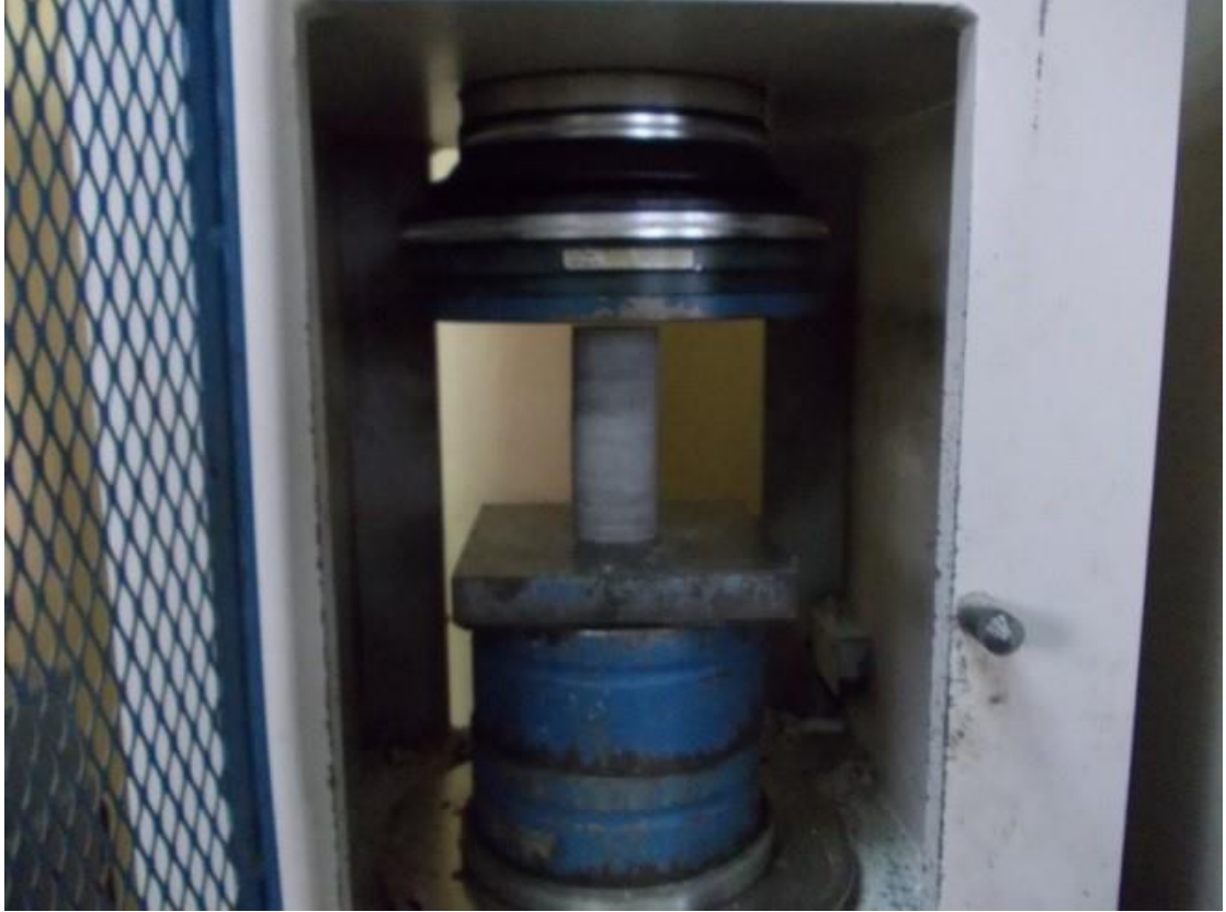
Şekil 6.4. 300 ton kapasiteli hidrolik pres (Kahraman, 2014).
